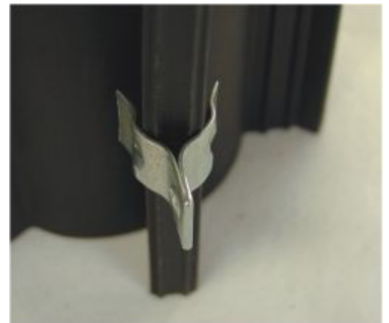
Befestigung des Schwindrohres
